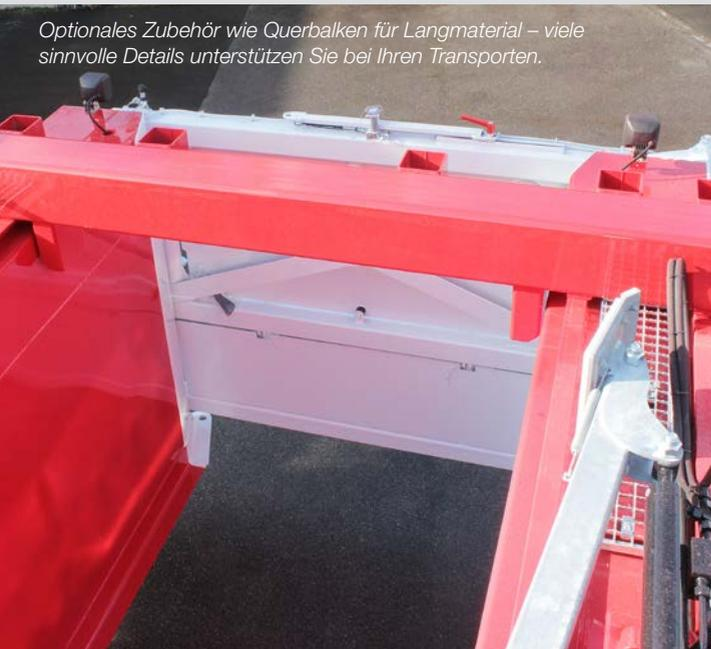
*Manuell oder optional hydraulisch – die Fixierung passt sich individuell der Ladung an und ist schnell und sicher vom Boden zu bedienen.*
