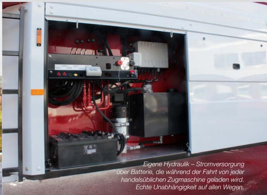
*Eigene Hydraulik – Stromversorgung über Batterie, die während der Fahrt von jeder handelsüblichen Zugmaschine geladen wird. Echte Unabhängigkeit auf allen Wegen.*
