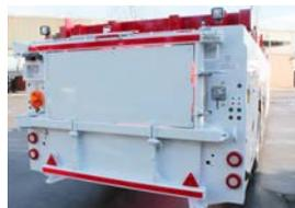
*Hydraulische Fixiereinrichtung, geschlossene Hecktür, nach oben öffnende Hydraulikportale oder als Kombi-Tür – für Ihren Innenlader sind viele Optionen nach Maß möglich.*
