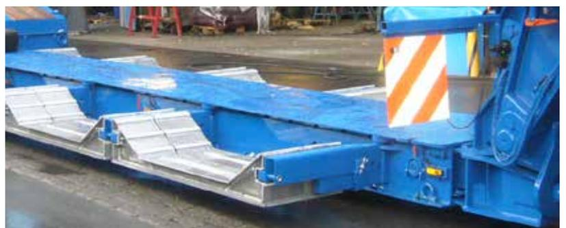
Zurringe mit geprüfter Belastbarkeit, individuelle Zurrpunkte durch das Langendorf Vario-Lash-System, Rungenaufnahmepunkte und Rungenhalterungen, Containerverschlüsse, Rad-Wendemulden, Seilwinden, Anschlagkeile, Zusatzbeleuchtung – die Liste der individuellen Ausstattungsmöglichkeiten ist so vielfältig wie ihre Transportanforderungen.
