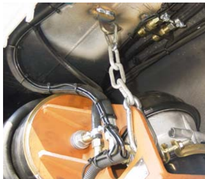
Absperrhähne der Luftfederbälge
