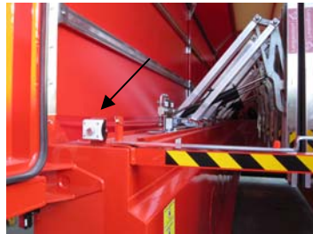
Überbrückung der Torsicherheitsschaltung
