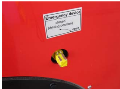
Notlaufsicherung „geöffnet“ (Fahrzeug kann abgesenkt werden)
