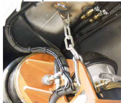
Dispositif pour changer la roue à l'Innenlader avec suspension pneumatique
