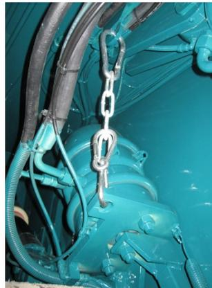
Radwechselhilfe am hydr. gefedertem Innenlader
