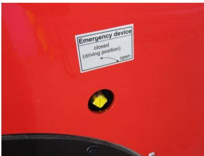
Notlaufsicherung in Fahrstellung
