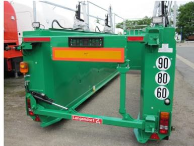
Die Steuerventile für die schwenkbare Rückwand befinden sich auf der linken Fahrzeugseite im hinteren Bereich. Bevor die Rückwand geöffnet werden kann müssen die beiden mech. Sicherungen (Steckbolzen) gelöst werden.
