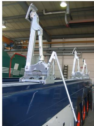
1. Bevor der Innenlader beladen werden kann müssen alle Pratzen vollständig geöffnet sein.
