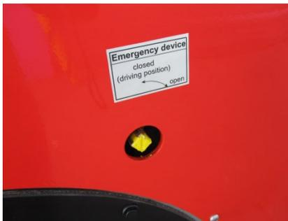
Notlaufsicherung in Fahrstellung
